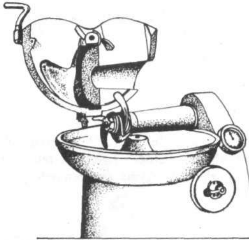
12. ábra. Gyorsvágó gép nyitott fedéllel, 3 késsel
